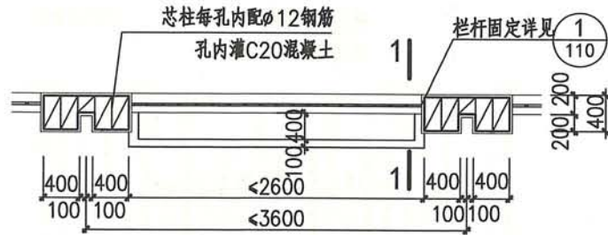
混凝土砌块围墙平面
