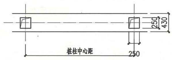
砖砌条形基础平面
