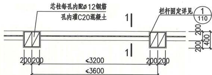
混凝土砌块围墙平面
