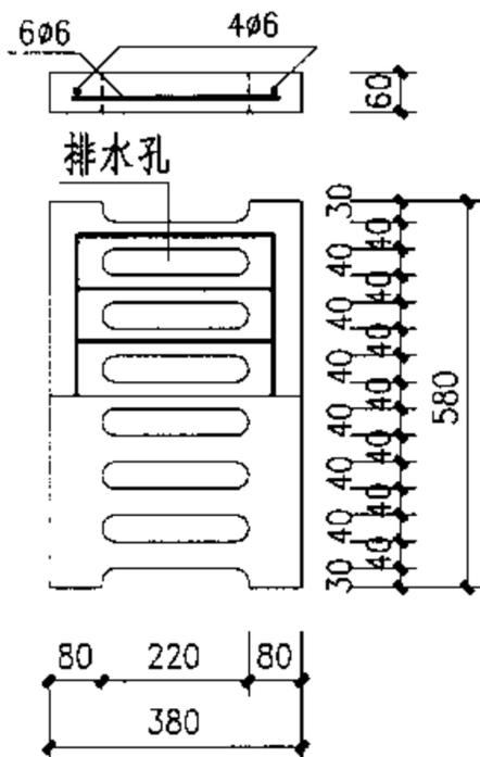
① 钢筋混凝土篦子
