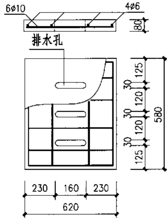
③ 钢筋混凝土篦子
