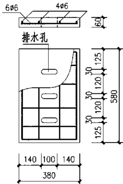
② 钢筋混凝土篦子
