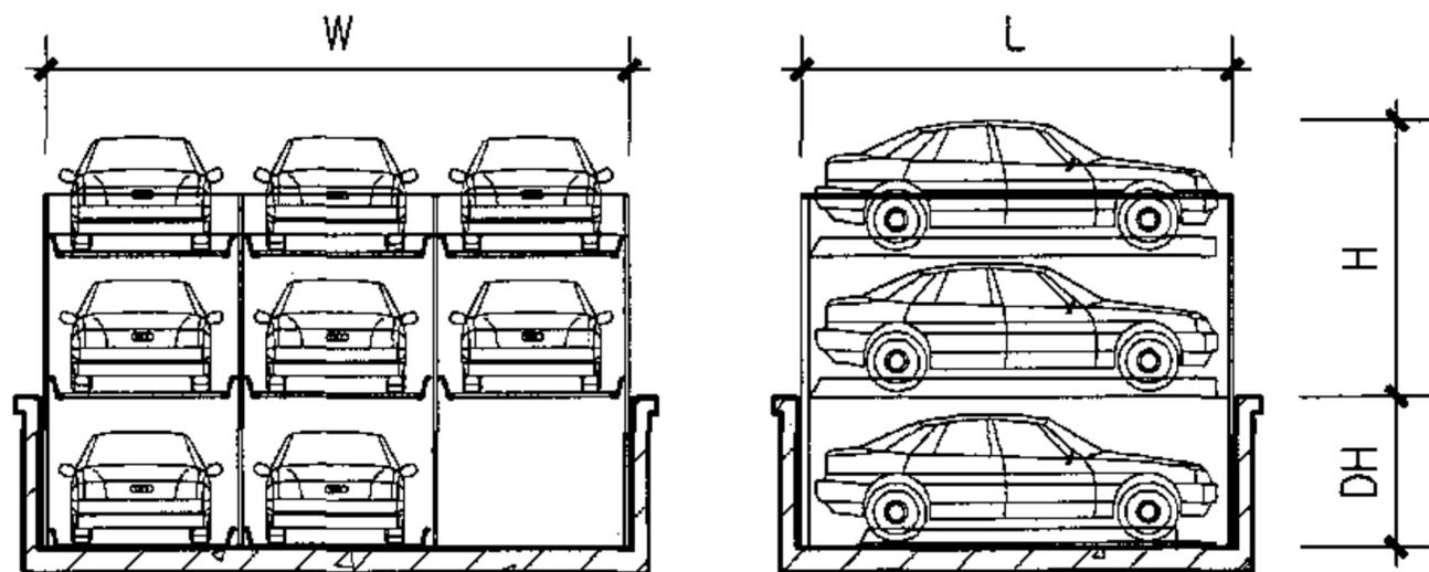
图2 升降横移机坑三段式
