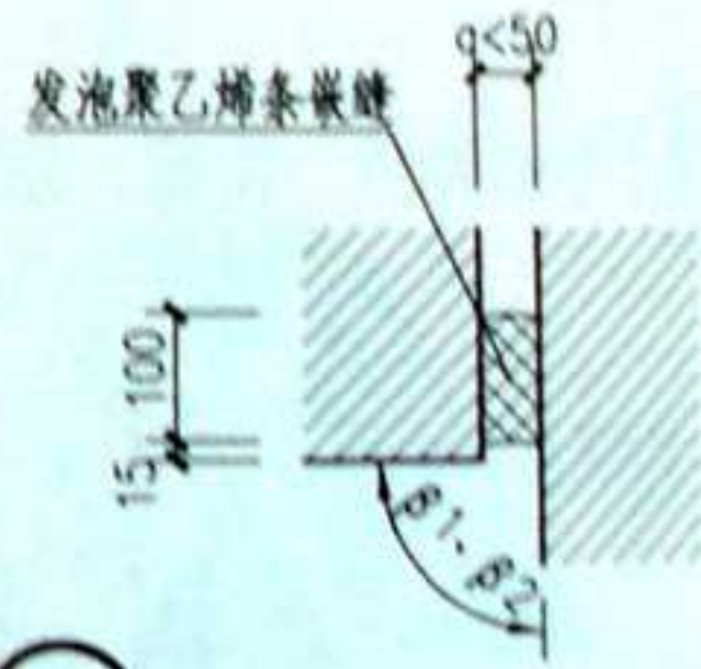
⑥ 外墙伸缩、沉降缝
