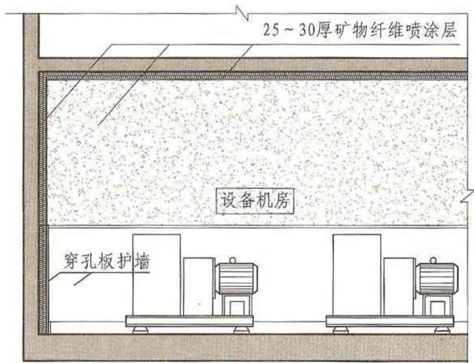
设备机房剖面图 设备机房吸声降噪
