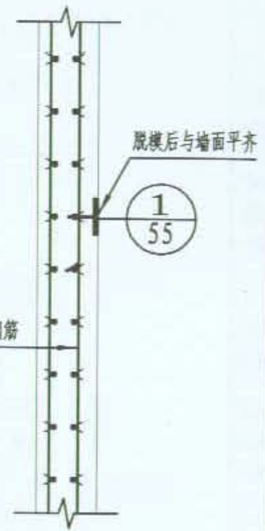
钢筋混凝土墙连接板安装
