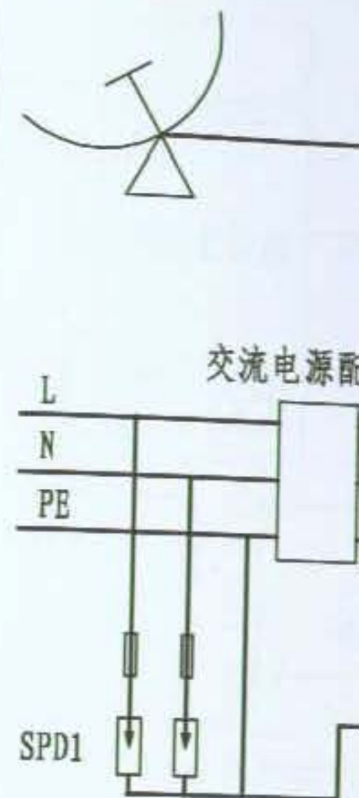
卫星通信系统过电压保护
