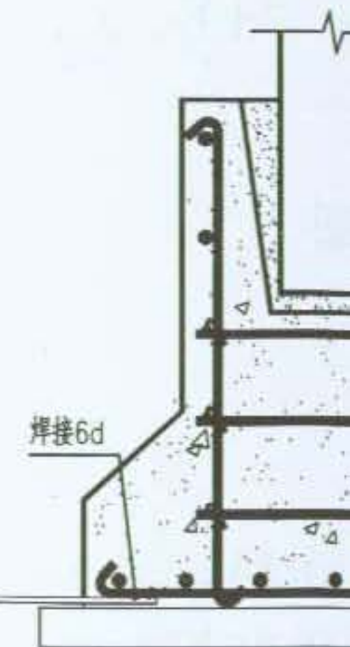
杯口型(有垂 基础钢筋
