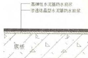
卫生间底板防水构造示意图
