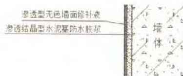
外墙墙体防水构造示意图
