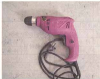
电钻示例图 (用于蒸压加气混凝土产品上打孔)
