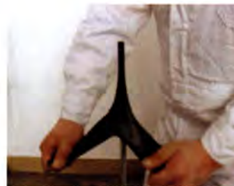
产品耐穿刺性能试验
