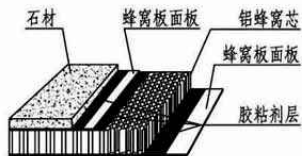
图C-1 石材蜂窝板的基本构造
