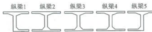
图 4.3-31 折面梁格模型截面划分示意
