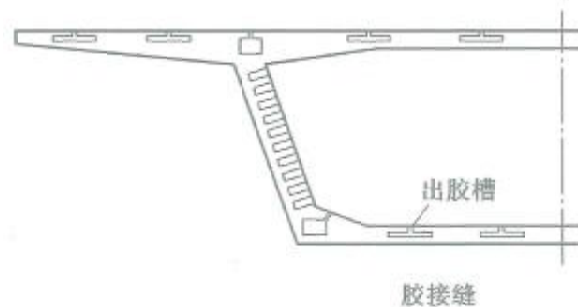
图 9.3-7 剪力键布置示意
