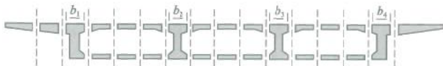
图 4.3-9 截面的致密划分可直接表达剪力滞效应
