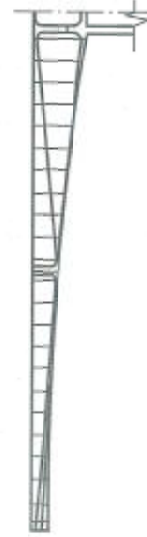
图5.2-7 悬臂拼装箱梁的预应力布置示意
