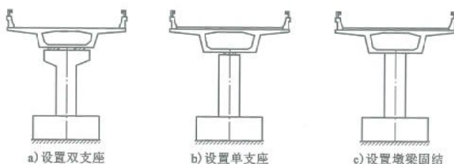
图 4.4-8 跨中桥墩的典型构造
